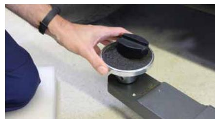
Aufnahmetellersystem (ATS) mit Stecksystem für Schwenkarme oder Gummiteller (120mm).
